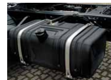
Nella pagina a fianco, lo Stralis 8x2x6 a 4 assi 2+2 e, sotto, la versione 1+3. In basso, lo Stralis Super Light con, qui, il particolare della monogomma e del serbatoio di plastica.
