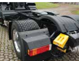
Nella pagina a fianco, lo Stralis 8x2x6 a 4 assi 2+2 e, sotto, la versione 1+3. In basso, lo Stralis Super Light con, qui, il particolare della monogomma e del serbatoio di plastica.
