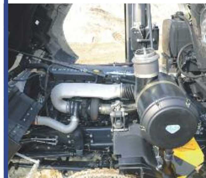
Nella pagina accanto, l'Astra HD9 84.48 8x4 durante un passaggio veloce in cava. A fianco, i particolari del motore Fpt Cursor 13 da 480 Cavalli
